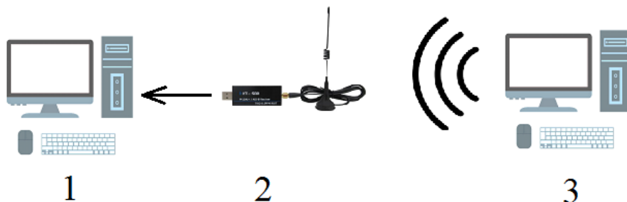
Рис 1. Структурная схема исследования ПЭМИН видео интерфейса DVI: 1-компьютер со специальным ПО для декодирования ПЭМИН излучения; 2-SDR приемник для приема ПЭМИН излучения; 3- исследуемый объект (видеокарта ПК подключенная к монитору DVI-D кабелем);
