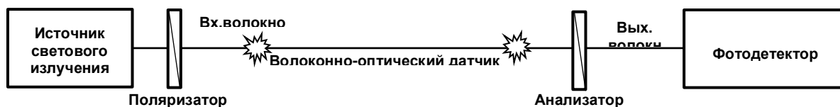
Рис. 10. Схема типичного поляриметрического волоконного датчика.
